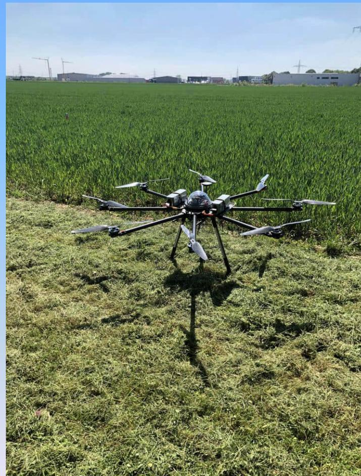
Luftgestützte magnetische Sondierung
